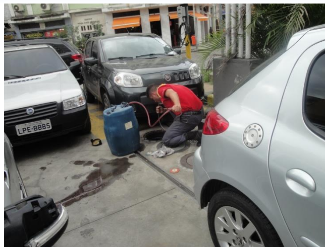
Transferência de combustível líquido contendo benzeno com uso de mangueira por sucção oral
